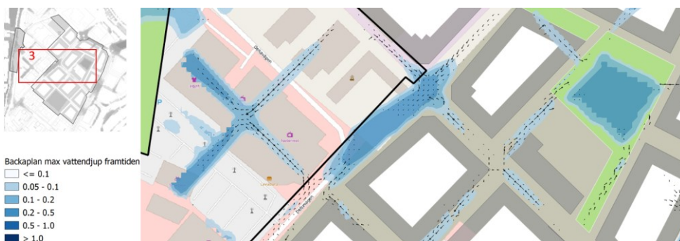
Figur 20 Vattendjup vid Park 2 och längs Deltavägen. Pilarna anger flödesriktning. Pilarnas storlek representerar storleken på flödet där en större pil innebär ett större flöde.
