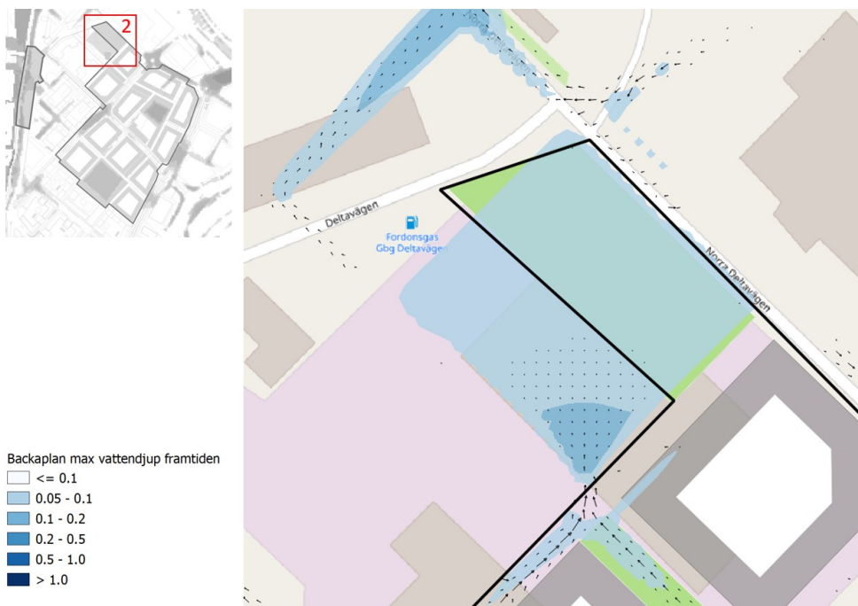
Figur 19 Vattendjup vid Park 1. Pilarna anger flödesriktning. Pilarnas storlek representerar storleken på flödet där en större pil innebär ett större flöde.
